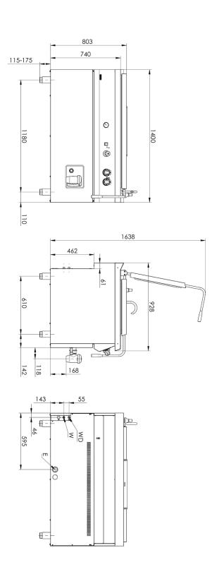
E - přívod napětí 400V WD - přívod vody do duplikátrou W - přívod vody
